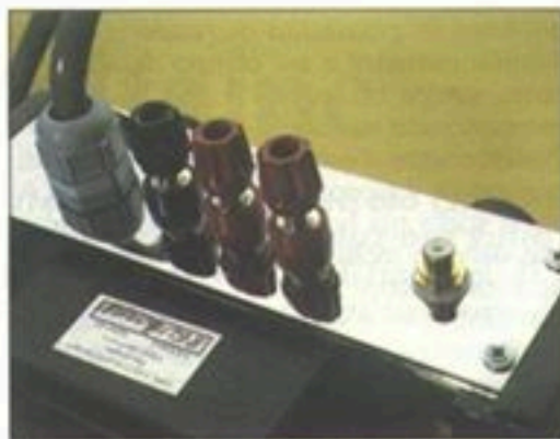
Ben dimensionati i morsetti d'uscita nonostante la modesta potenza.
